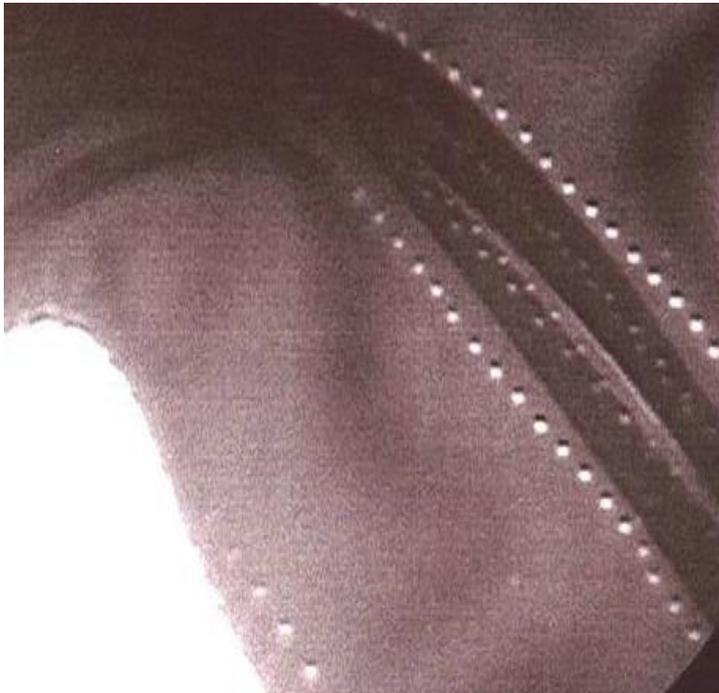
Deutlich sind hier die Nahtlöcher eines herkömmlichen Standard Schilddrüsen-Schutzkragens in Kappenform zu erkennen.
